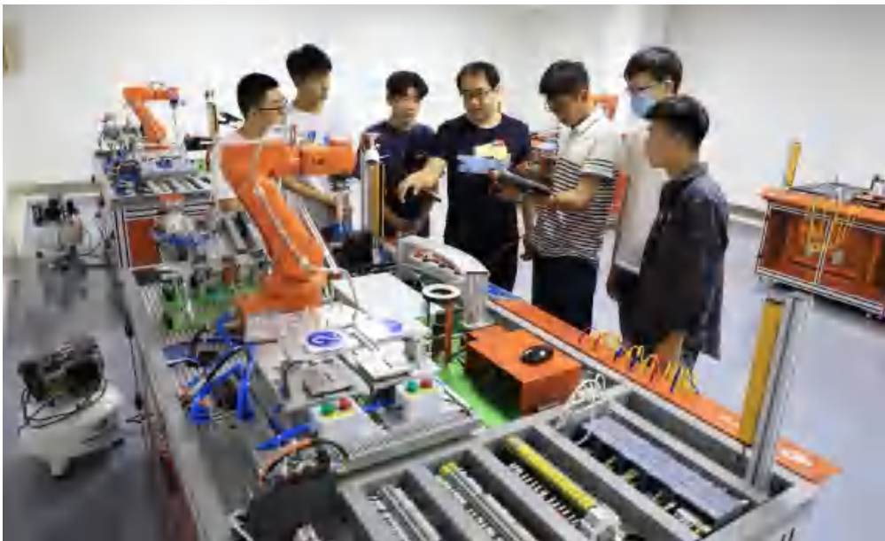
图 18：研发团队带领学生进行工业机器人离线涂胶实验
